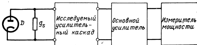
Рис. 3.7. Схема для измерения коэффициента шума усилительного каскада на данной частоте.
